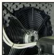
Ventilación forzada para una mejor refrigeración. Para las versiones a estrella-triángulo, el ventilador funciona bajo termostato.
