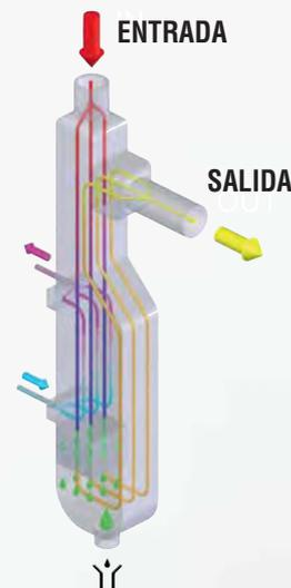
Los datos que se indican hacen referencia a las siguientes condiciones nominales: temperatura ambiente 25°, con aire de entrada a 7 bar y 35°C y un punto de rocío a presión de 5°C (punto de rocío a presión atmosférica -20,5°C). Máx. condiciones de funcionamiento: temperatura ambiente 45°C, temperatura entrada aire 55°C y presión entrada aire 14 bar (16 bar para AMD 6...18).
