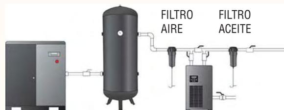
COMPRESOR      DEPÓSITO      SECADOR
