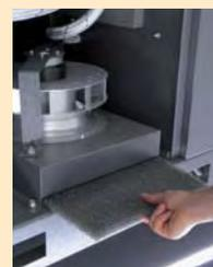
**Paneles de prefiltración del aire de refrigeración**
