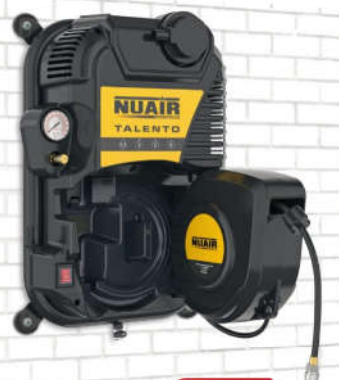
TALENTO 1.5 hp. Caldera 2 lts. 160 lts./min. 230VII 8 bar. Sin aceite. 69 dB(A). Enrollador con 9 mts. de manguera.
