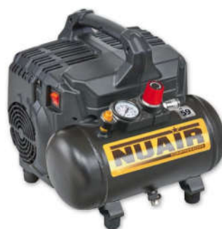
SILTEK + Nuair 1 hp caldera 6 lts. 105 lts./min. 59dB(A) 8 bar. Sin aceite.
