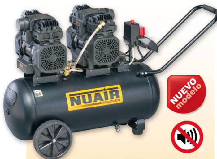
SILTEK TB 50D 3 hp caldera 50 lts. 320 lts./min. 230VII 64 dB (A). 8 bar. Sin aceite.
