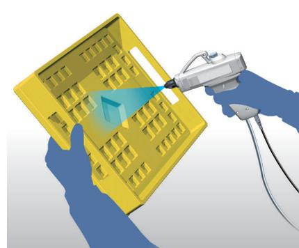
Neutralización de la electricidad estática y eliminación de polvo de sustratos eléctricos
