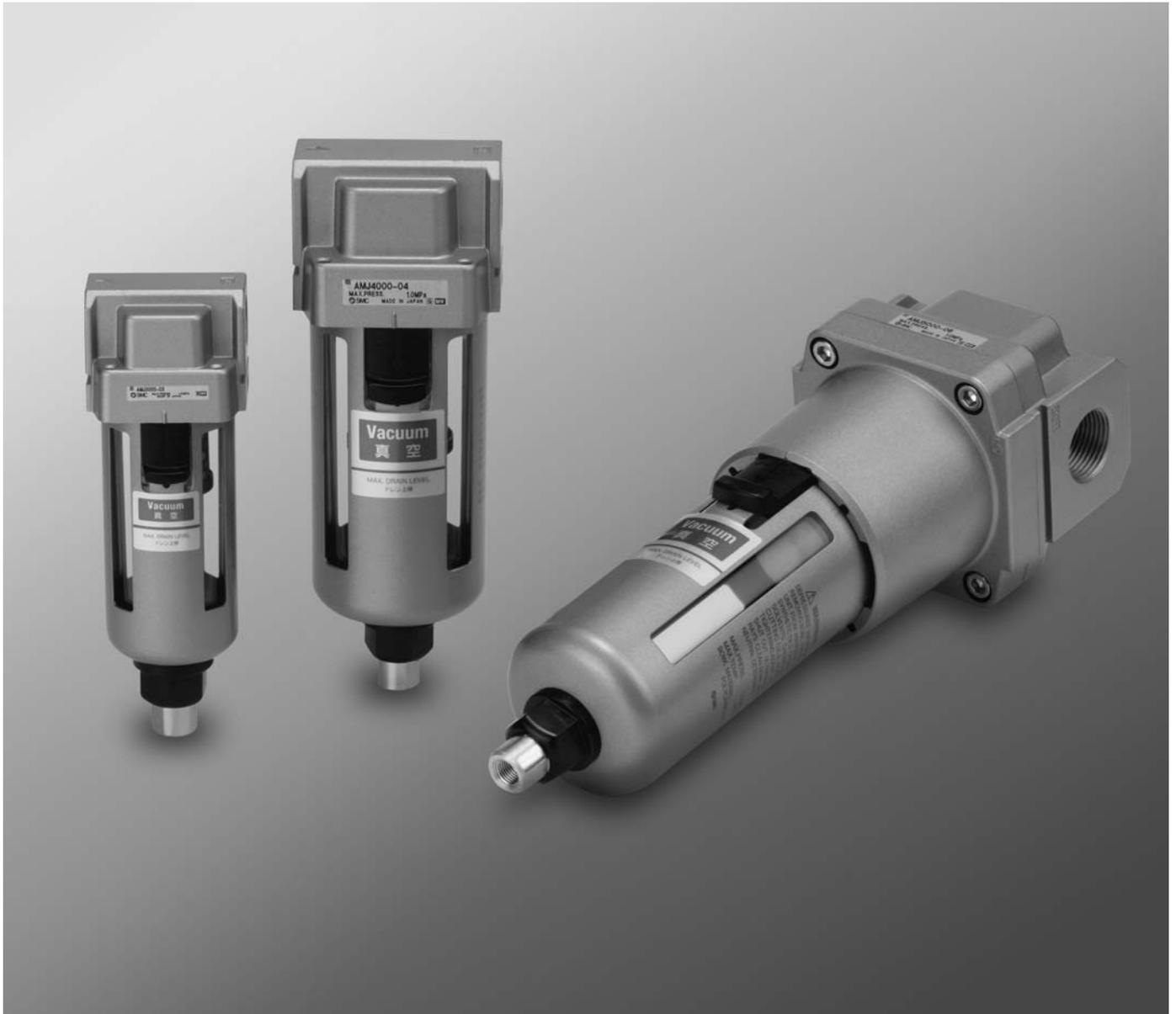
**Extrae gotas de agua del aire mediante una simple instalación de líneas de conexión de equipo de vacío. Idóneo para extraer gotas de agua del aire succionado en bombas de vacío y eyectores, etc.**
