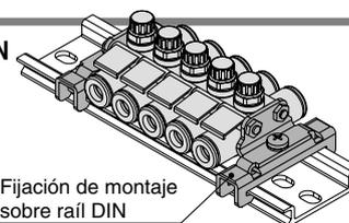
Fijación de montaje sobre raíl DIN
