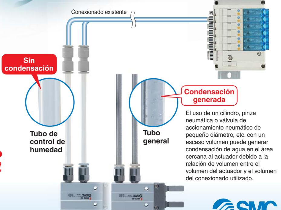
El uso de un cilindro, pinza neumática o válvula de accionamiento neumático de pequeño diámetro, etc. con un escaso volumen puede generar condensación de agua en el área cercana al actuador debido a la relación de volumen entre el volumen del actuador y el volumen del conexionado utilizado.
