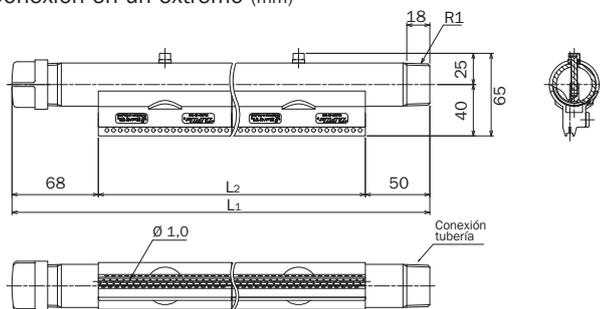
**Conexión en ambos extremos (mm)**
