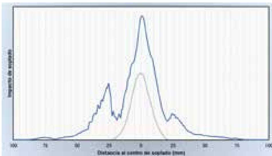
En la gráfica se observa la diferencia en la distribución de la fuerza de soplado entre un tubo abierto (gráfica azul) y una boquilla de la serie TFR (gráfica gris).
