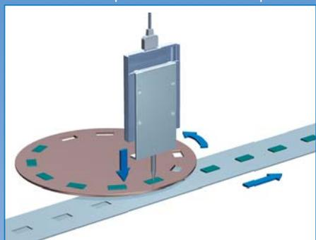
Separación de componentes (cilindro de retención)
