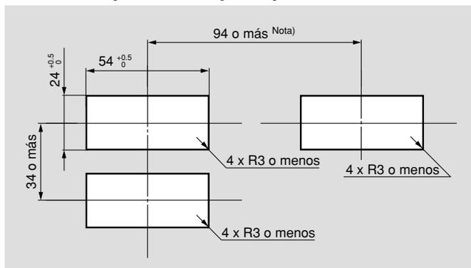
Espesor del panel 1 a 3.2 mm
