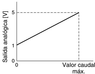
Salida de tensión analógica (1 a 5 V)
