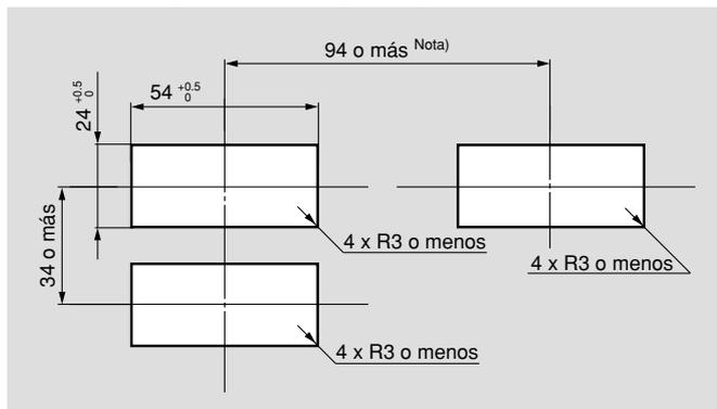
Espesor del panel 1 a 3.2 mm
