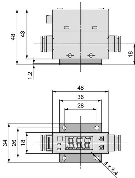
Con fijación/con válvula de regulación de caudal
