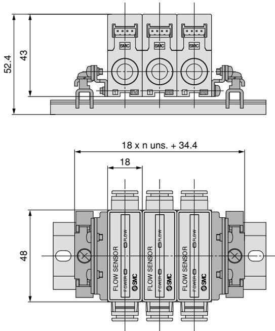
Cableado con conector ZS-33-D
