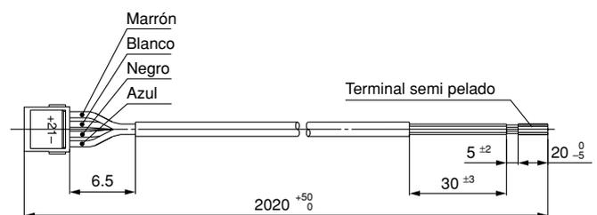
Características técnicas del hilo conductor con conector
