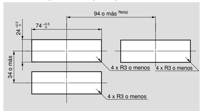
Espesor del panel 1 a 3.2 mm
