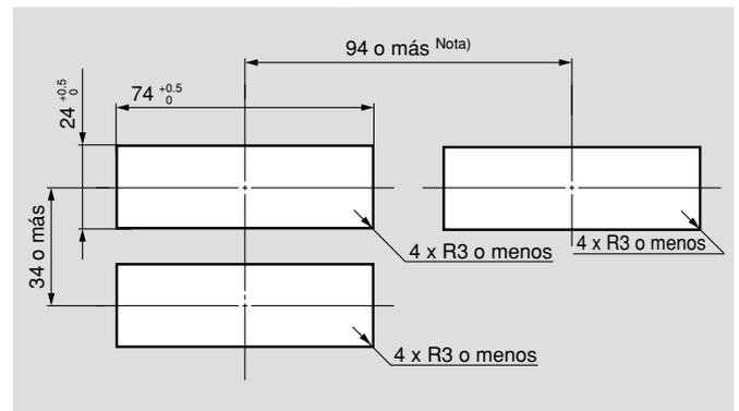
Espesor del panel 1 a 3.2 mm
