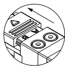
Estado desbloqueado del conmutador de accionamiento manual
