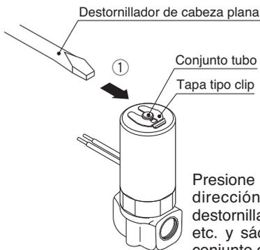
Presione la tapa tipo clip en al dirección ① con un destornillador de cabeza plana, etc. y sáquela de la ranura del conjunto del tubo.
