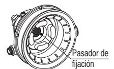
7. La conexión instantánea recomendada para montaje en la conexión PD es la KQ2S06-01□S o KQ2S07-34□S.
