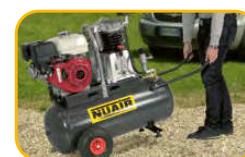
La doble asa y las ruedas semi-neumáticas permiten el transporte sobre casi todo tipo de suelo
